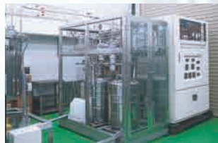
现象液稀释供给精密过滤装置
