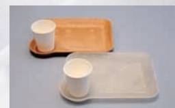
普鲁兰(pullulan)和生化分解性塑料 (上:混合日本扁柏, 下:只有普鲁兰)
