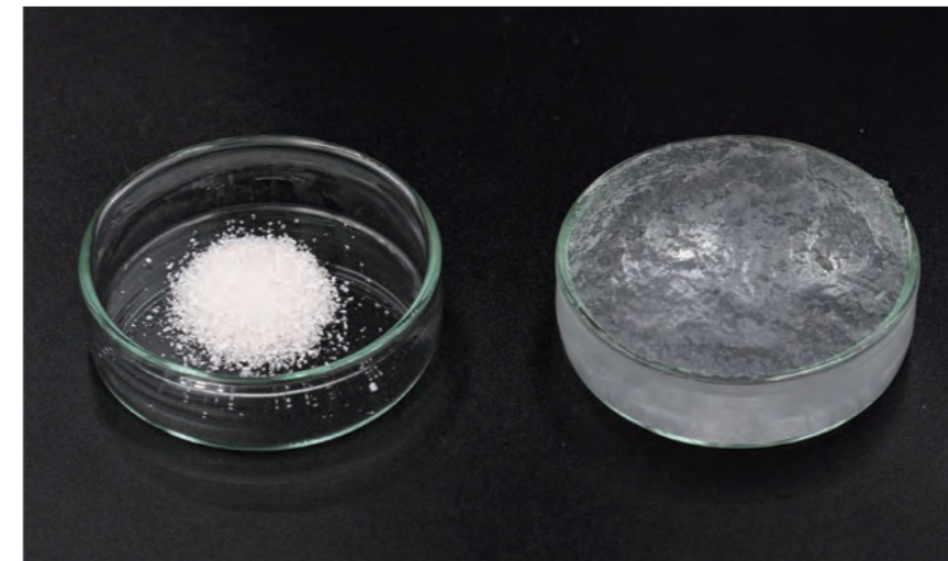
バイオ由来の原料比率を高めた開発品SAPの吸水前(左)と吸水後(右)
