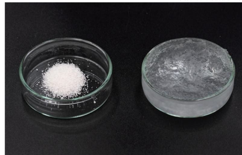
提高生物衍生材料比例开发而成的产品SAP在吸水前(左)和吸水后(右)的对比
