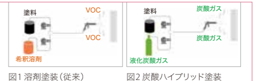
図1 溶剤塗装(従来) 図2 炭酸ハイブリッド塗装
