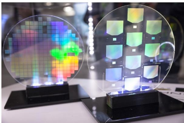
1. Inkron 社の高屈折 IOC 材料を使用し、EVG 社 NIL 装置を用いて SCHOTT 社基板にナノインプリントした回折構造体
