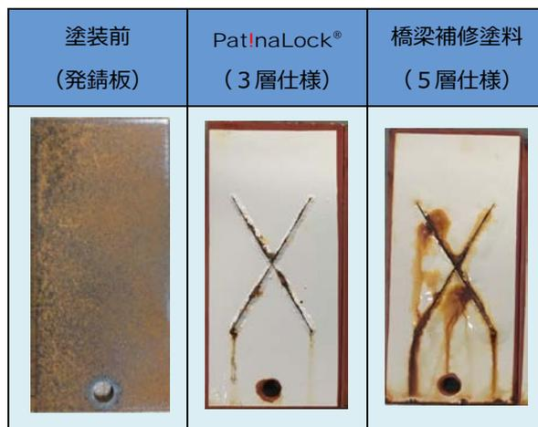
【「Pat!naLock®」および一般橋梁補修塗料使用のサイクル腐食試験 (JIS K5600 7-9)
