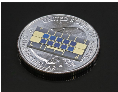
トライルミナ社製 300W 出力 VCSEL モジュール（約 8mm×16mm）
