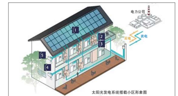
(1)太阳能电池模块(发电),(2)连接箱(集电),(3)电力调节器(将电气转为电力),(4)表示机器(观看电力),(5)屋内分电盘(送电)
