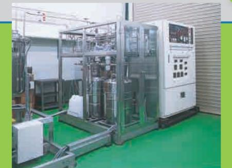
显像液稀释供给精密过滤装置
