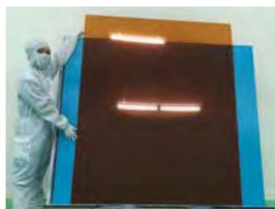
東洋紡(株)との合併で設立したゼノマックスジャパン(株)の本社工場が完成し、2019年に製品の出荷を開始しました。東洋紡が持つ高耐熱ポリマーの合成技術や、フィルム製膜技術などを駆使した「ゼノマックス®」は、室温から500°Cまで熱膨張係数が一定で、ポリマーフィルムとして世界最高レベルの寸法安定性を持つ高耐熱性ポリイミドフィルムです。お客様の生産ラインに合わせて最大G6(1500×1850mm)までガラスと貼り合わせての供給が可能で、電子ペーパー、ミニLED、マイクロLEDといった次世代ディスプレイや各種センサー用基材、半導体向けに展開しています。
